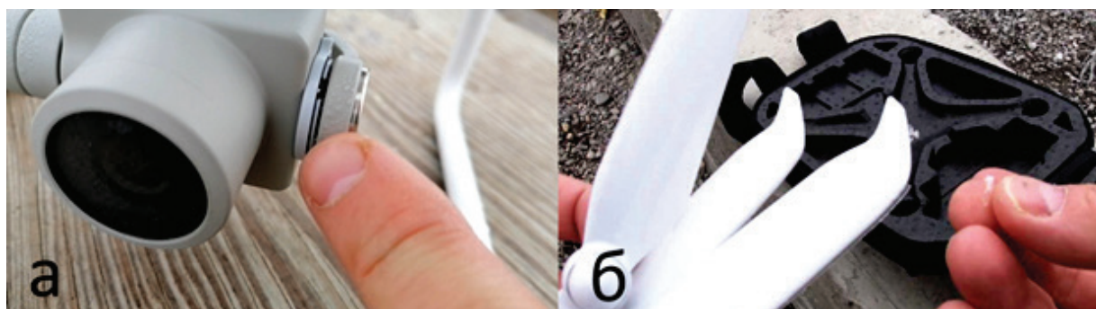
Рис. 5. Воздействие высокой влажности и низких температур на беспилотную технику. Видны капли влаги на камере (а) и кромка льда на пропеллерах (б).
