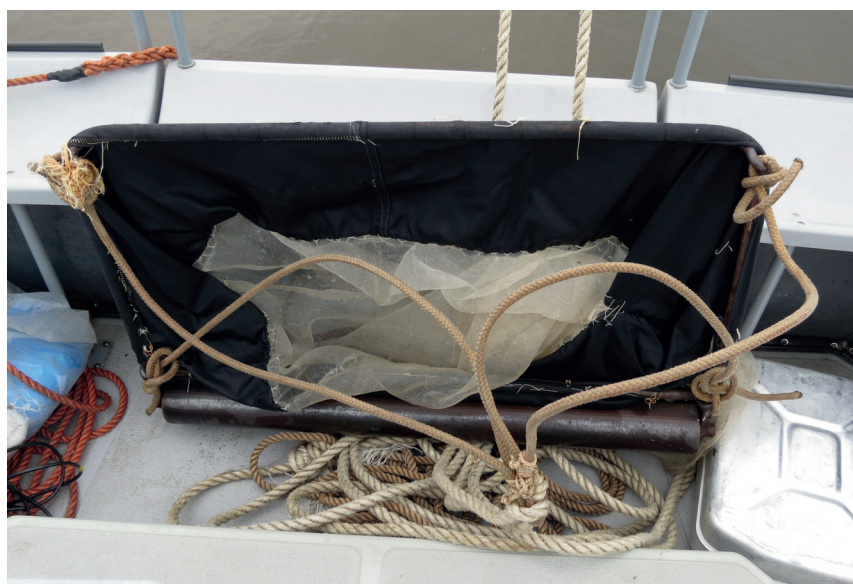
Рис. 2. Стандартный мальковый бим-трал для учёта молоди рыб и креветок в придонном слое.
