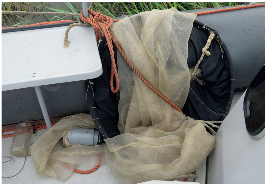
Рис. 3. Стандартная мальковая ловушка ИКС-80 для учёта молоди рыб и креветок в поверхностном слое.
